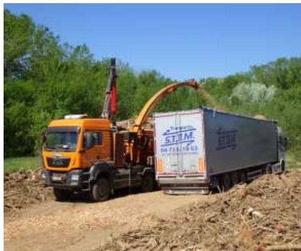
**Une déchiqueteuse de 480 ch capable de broyer des arbres de 60 cm de diamètre**
